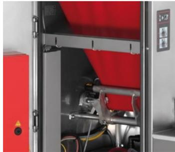
Seitlicher Mechanismus, um den Pulversack zu bewegen. So bleibt kein Pulver hängen und das Pulver kann gleichmäßig dosiert werden.
